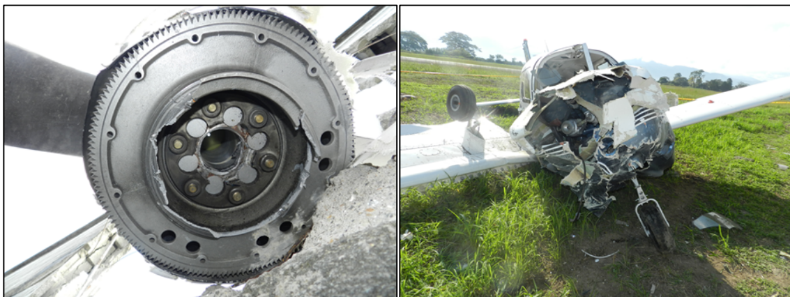
Fotografías No. 3 y 4: Daños en el motor y parte frontal de la aeronave
