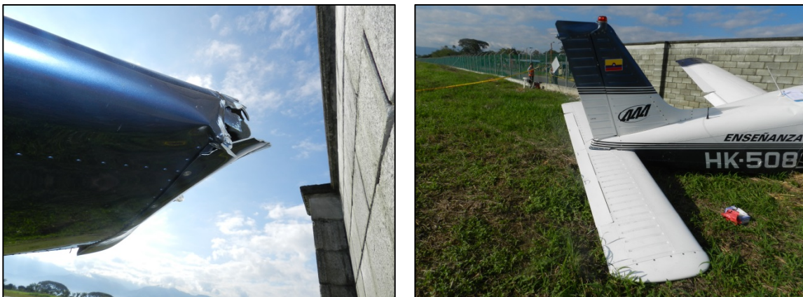
Fotografías No. 8 y 9: Daños en planos y estabilizadores.
