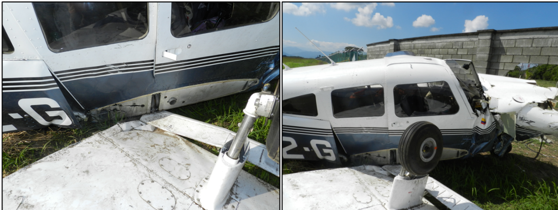
Fotografías No. 6 y 7: Daños en fuselaje y planos.
