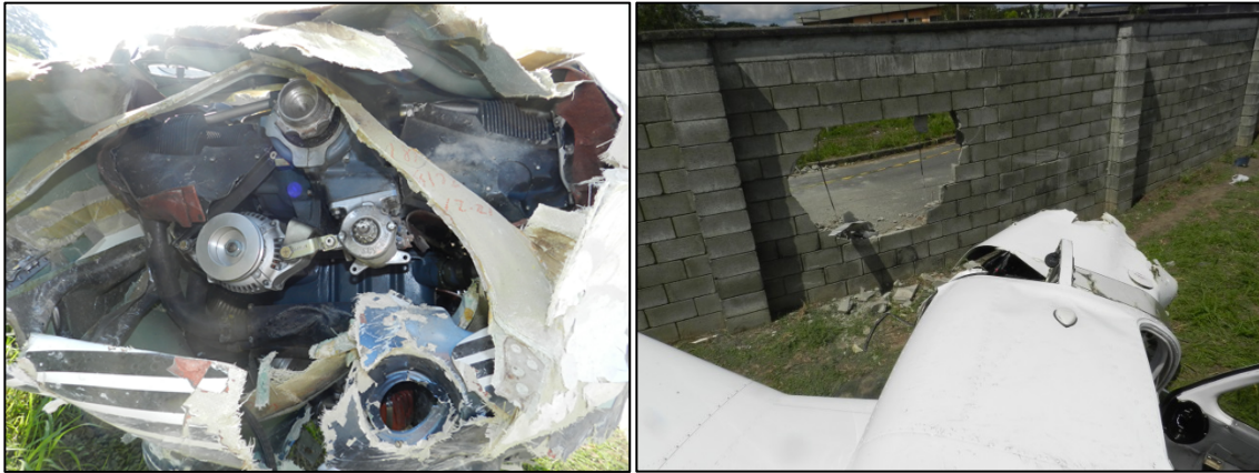
Fotografías No. 4 y 5: Daños en hélice y motor.
