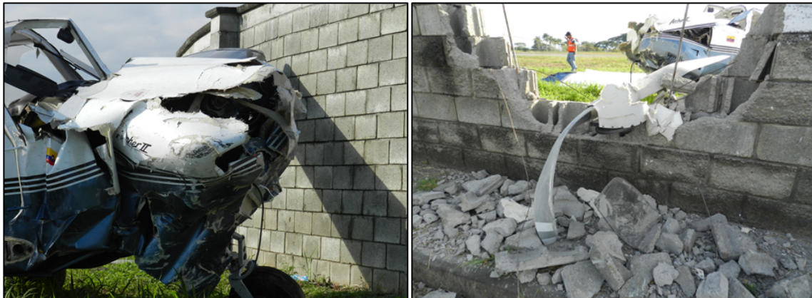
Fotografía No. 3: Impacto frontal contra el muro
